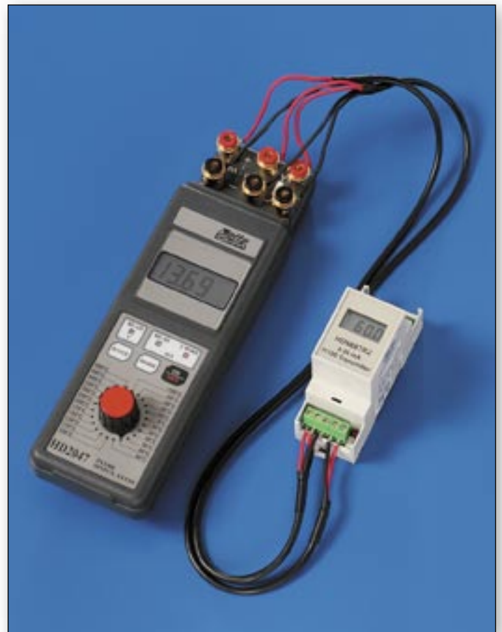
Fig. 3 Verificação de um transmissor passivo com entrada para Pt100.
